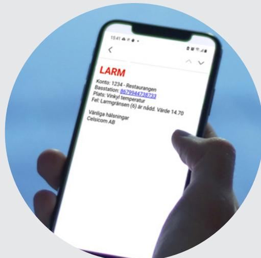
Når du har montert og satt opp måleboksen (som ikke tar veldig lang tid, se side 9) du trenger ikke lenger bekymre deg for at grensene overskrides. Så snart en fastsatt grenseverdi overskrides, sender boksen sender automatisk en alarm til skytjenesten og videre til utvalgte brukere via SMS og/eller e-post, slik at de kan handle og raskt ta det passende handlinger.
